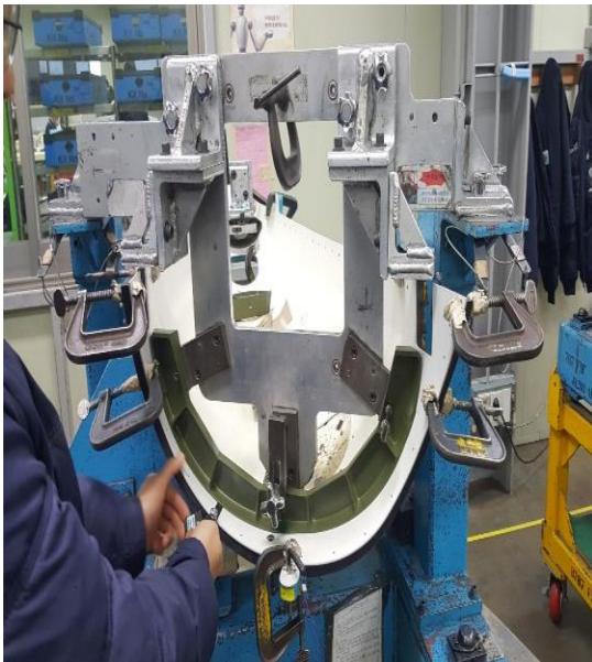
787 FSF FAJ ROOM GAP INSPECTION
